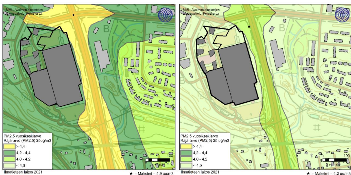
Kuva 14. Leviämislaskelmin saatu liikenteen päästöjen ja taustapitoisuuden yhteisvaikutuksen aiheuttama pienhiukkasten (PM 2,5 ) vuosiraja-arvoon verrannollinen pitoisuus kaavamuutosalueen lähiympäristössä hengityskorkeudella nykytilanteessa (vasen kuva) ja tulevassa tilanteessa (oikea kuva). Vuoden 2040 tilanteessa mukana on myös pysäköintihallien päästöt
